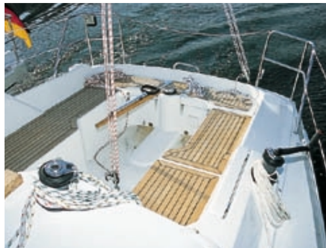
Die Hanse 311 liegt sauber im Wasser und holt sich den meisten Vortrieb aus dem mächtigen Großsegel. Die Instrumente über dem Schiebeluk sind sehr weit vom Rudergänger entfernt. Das Cockpit ist recht geräumig, das Fehlen des Travellers hat auch seine Vorteile
