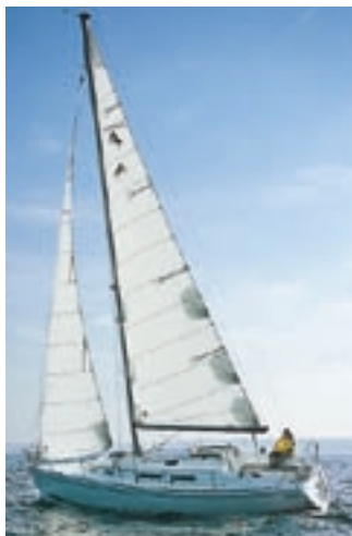
Die Hanse 311 liegt sauber im Wasser und holt sich den meisten Vortrieb aus dem mächtigen Großsegel. Die Instrumente über dem Schiebeluk sind sehr weit vom Rudergänger entfernt. Das Cockpit ist recht geräumig, das Fehlen des Travellers hat auch seine Vorteile
